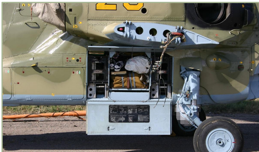
2-2 : Elicottero con coperture di accesso aperte e ala smontata
