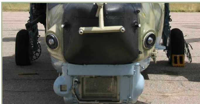
2-9. Vista dal naso. Piccola finestra in basso a sinistra della capsula: sensore di segnale laser anteriore. In alto, sui lati destro e sinistro, due occhi del rilevatore di lancio di missili UV. Due cilindri corti con cappelli bianchi nelle vicinanze: antenne IFF anteriori.
