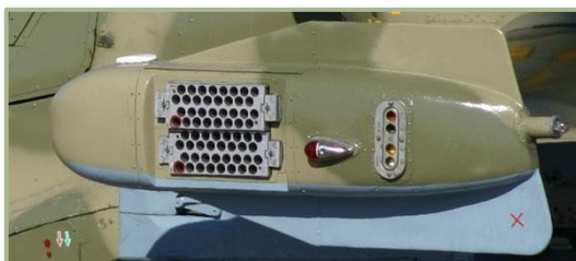
2-10. Due unità di erogazione di razzi UV-26 (a sinistra). Al centro c'è il distributore di cartucce di razzi a luce rossa e di segnali colorati (a destra).
