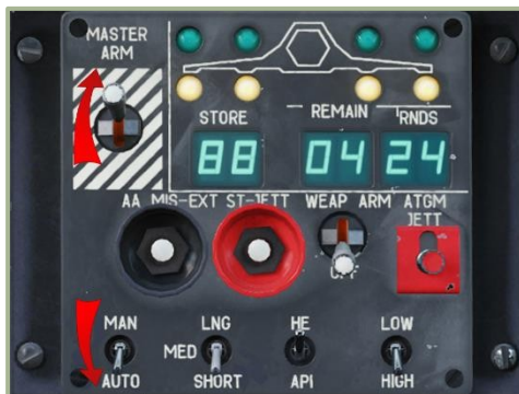
11-17 : Pannello di stato e controllo dell'arma PUI-800, modalità semi-automatica
