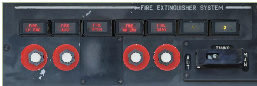
10-19 : Pannello di controllo dell'impianto antincendio
