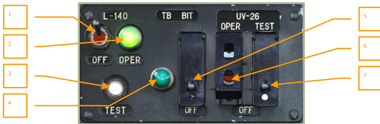
6-69 : Sistema di segnalazione laser L-140, sistema d'arma e pannello di controllo del sistema di contromisure UV-26
