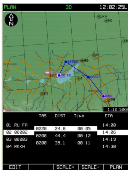
7-48 : Visualizza la sottomodalità VELOCITÀ con i valori immessi per l'ora di partenza e la TAS per le tappe del percorso
