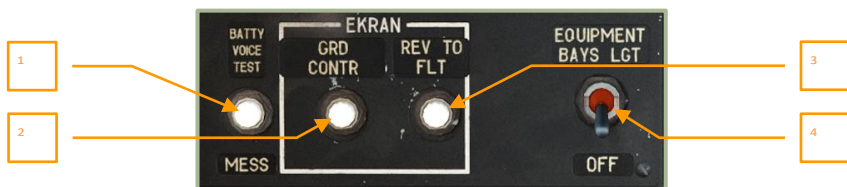
6-66 : Sistema di allarme EKRAN e unità di messaggio vocale ALMAZ ("Betty") Controlli BIT
