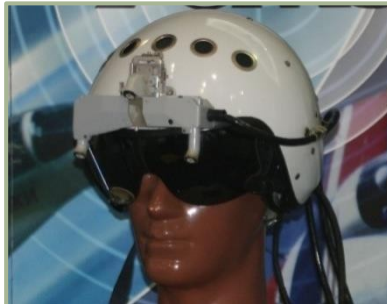
14-8 : Sistema di puntamento con mirino montato sul casco (HMS)
