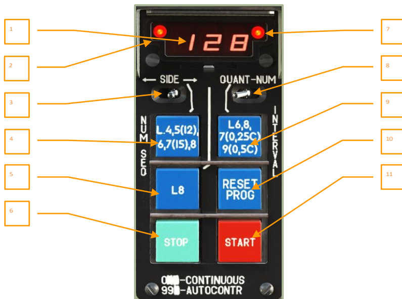
6-33 : Pannello di controllo delle contromisure UV-26
