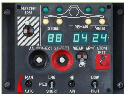
11-21: Pannello di stato e controllo dell'arma PUI-800, modalità manuale
