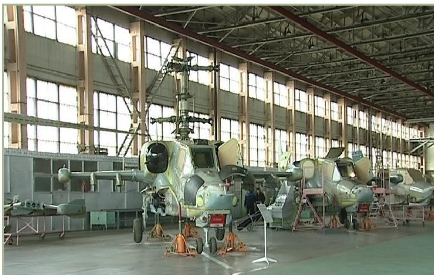
1-13 : Assemblaggio del Ka-50 nello stabilimento di costruzione di aerei "Progress"
