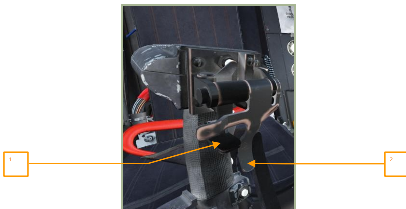
6-5 : I grilletti dell'arma (grande) e del cannone (piccolo) sono in posizione predefinita.
