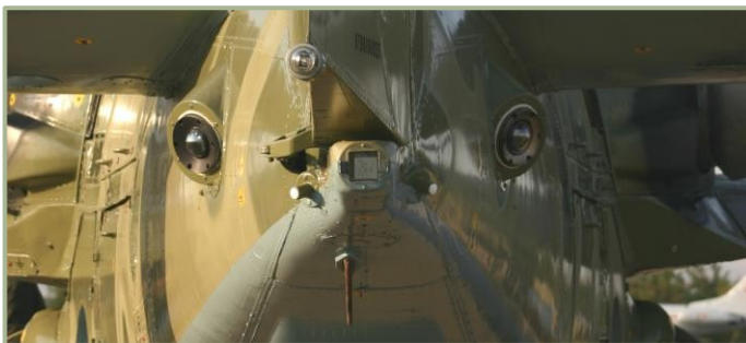
2-8. Vista dalla coda. Al centro, il sensore di segnale laser dell'L-410 Otklik Laser Detection Set. Due cilindri corti con cappelli bianchi vicini e un singolo perno verso il basso sono antenne del transponder IFF. Due occhi sui lati sinistro e destro - sensori di lancio di missili UV.
