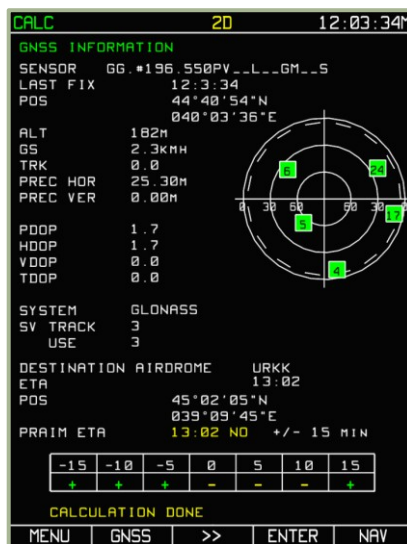
7-104 : Preparazione automatica dei dati per la visualizzazione dell'almanacco e l'esecuzione dei calcoli di previsione RAIM per l'aeroporto di destinazione.
